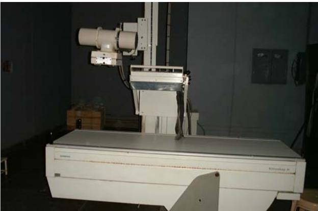
写真 5 : IGICH の X 線透視撮影装置 (モニターのない暗室型)
