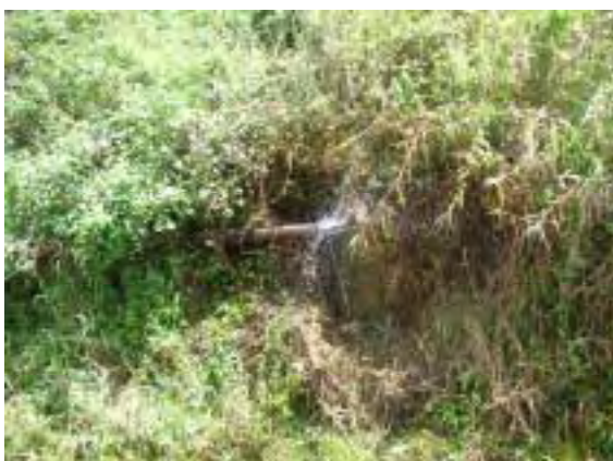
Fugas de Agua Detectadas en Investigaciones de Campo
