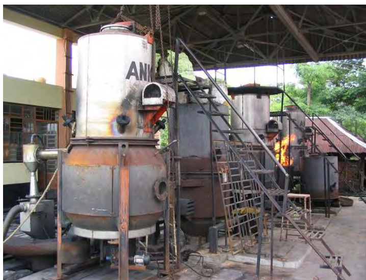
Figure AP-C.4.3 ゴサバ島エネルギー組合の 5 x 100 kW バイオマスガス化炉
