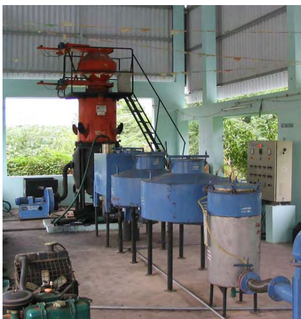
Figure AP-C.4.6 A 製造元の 40kW バイオマスガス化発電システム
