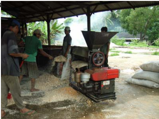
トウモロコシ: Sambas 県 Sanggau Ledo 郡における農民グループによるポストハーベスト状況。手前コーンシエラー、奥ボックスドライヤー。
