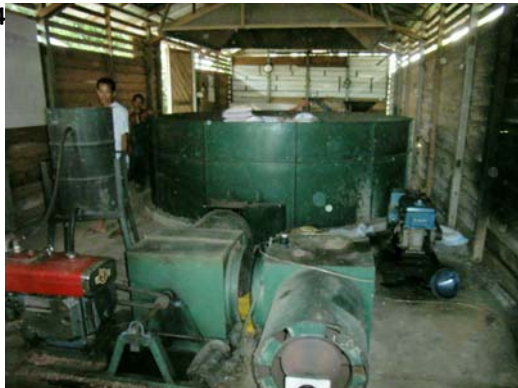
トウモロコシ: Singkawang 市 Sagatani 村の農民協同組合におけるポストハーベスト状況。円形のボックスドライヤーはグループ内外の生産者に利用されている。
