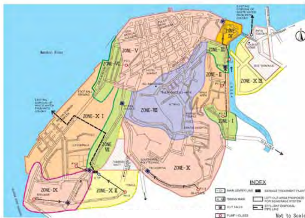
図 5-1-1 Panaji 市の污水排水区域図
