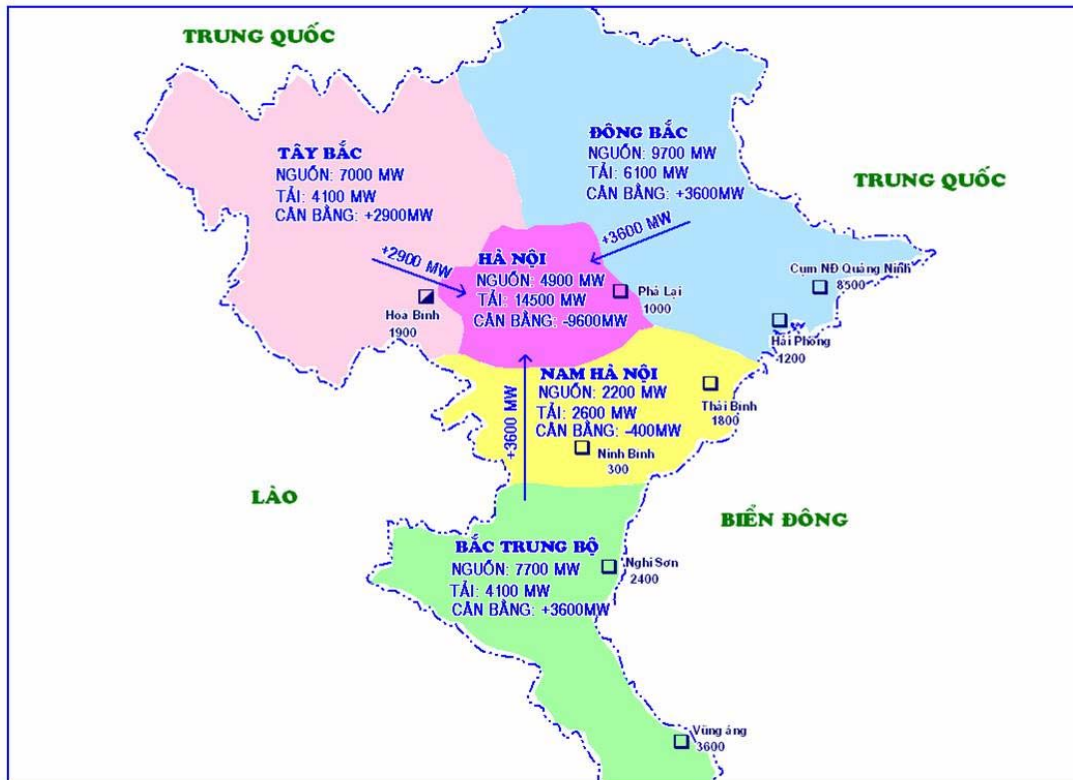
図 6-3-1 ベトナム 5 エリアのピーク時の需給バランスと概略の潮流
