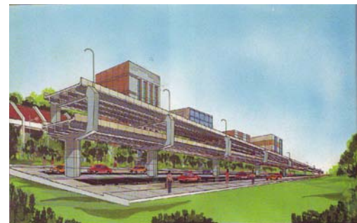
単柱橋脚ダブルデッキ構造
