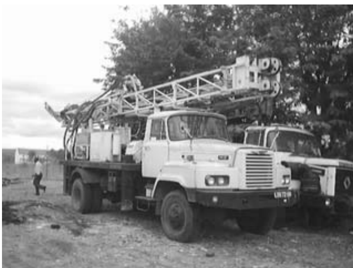
ルアンダ州給水計画で、供与されたトラック搭載型井戸掘削機（Catete にある DNA の資機材倉庫にて）
