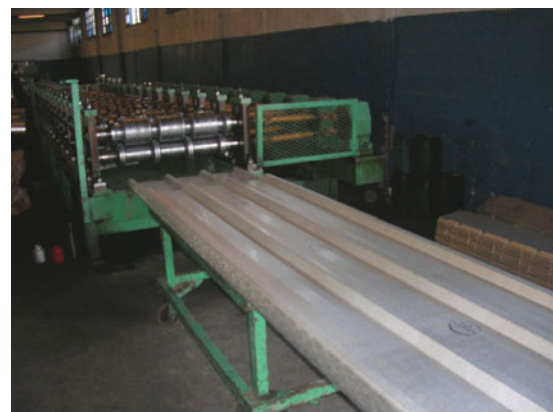
屋根折板 アルミ折板と成形加工機
