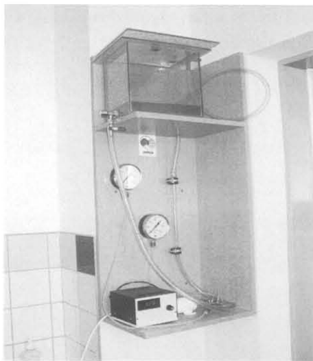
実験用省電力実験装置：水循環ポンプ装置（モーターは回転速度制御付き）
