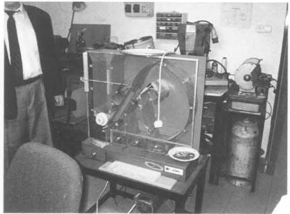
実験用リサイクル用ゴミ分別装置：風力選別式装置
