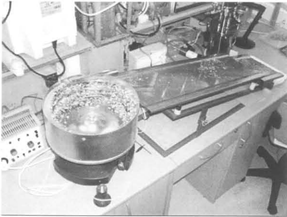
実験用リサイクル用ゴミ分別装置：振動篩式選別装置
