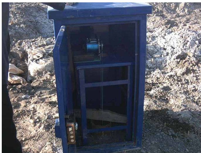
照片 7.1.1 JICA 观测井中设置的自记水位计
