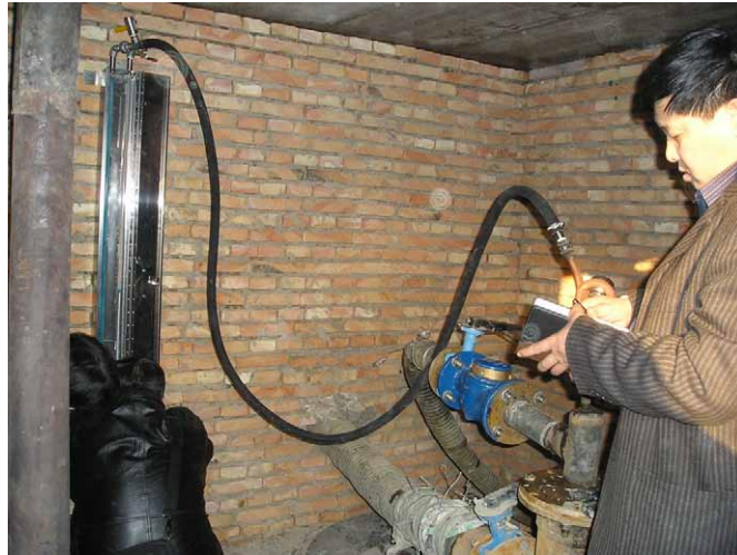
照片 7.1.3 TW-SW-1 观测井（自喷井）的地下水头测定
