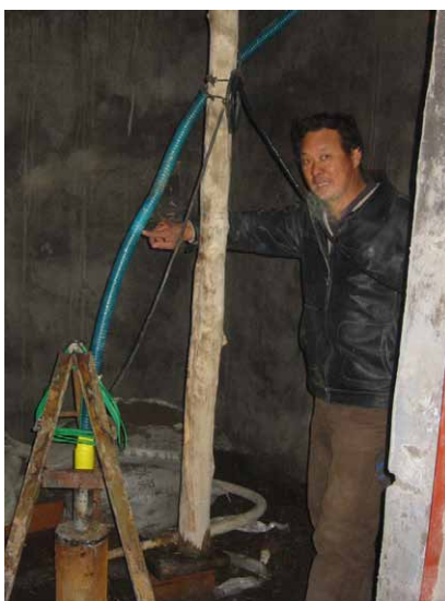
照片 7.1.2 TW-SS-1 观测井（自喷井）的地下水位测定
