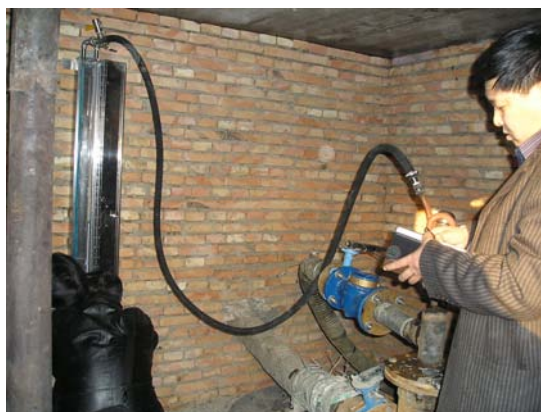
写真 7.1.3 TW-SW-1 観測井(自噴井)における地下水頭の測定
