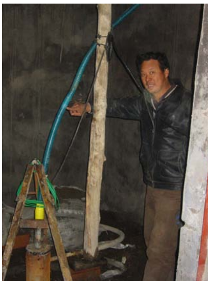
写真 7.1.2 TW-SS-1 観測井(自噴井)における地下水位の測定
