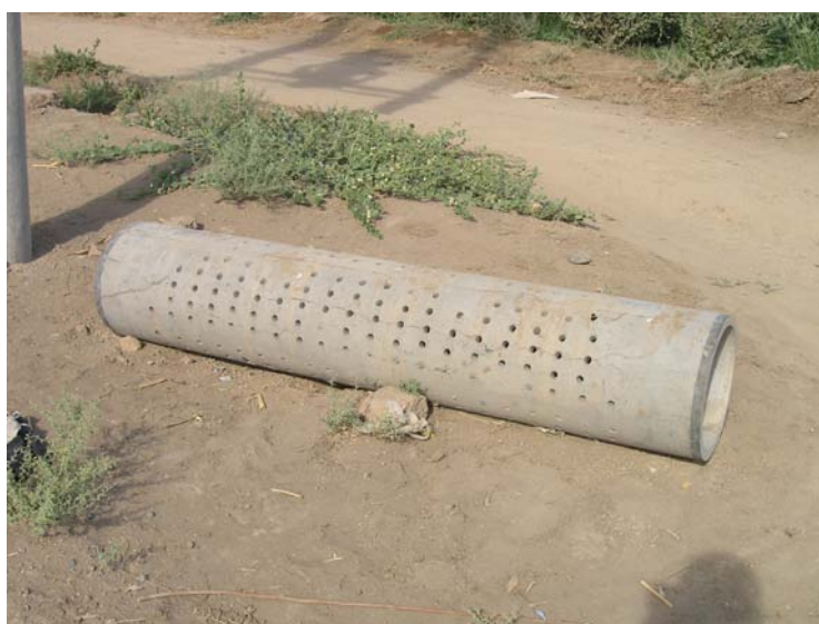
写真 5.4.1 井戸パイプに使われるコンクリート管
