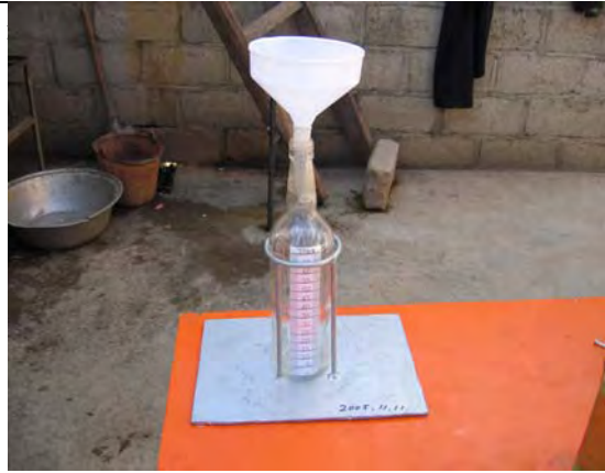
安装在铜都镇梁子上的测量仪器 2 简易雨量计。
