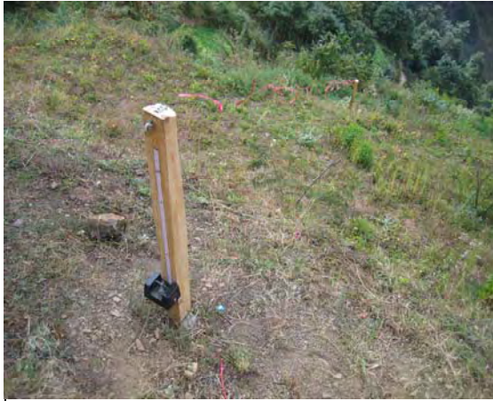
安装在铜都镇岩脚村梁子上的测量仪器 1 观测滑坡用的简易伸缩仪
