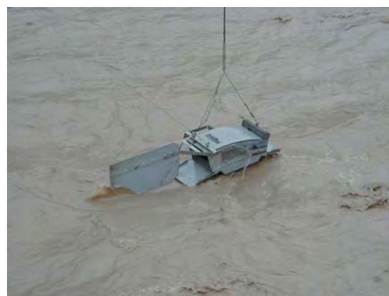
制作的推移质取样器
