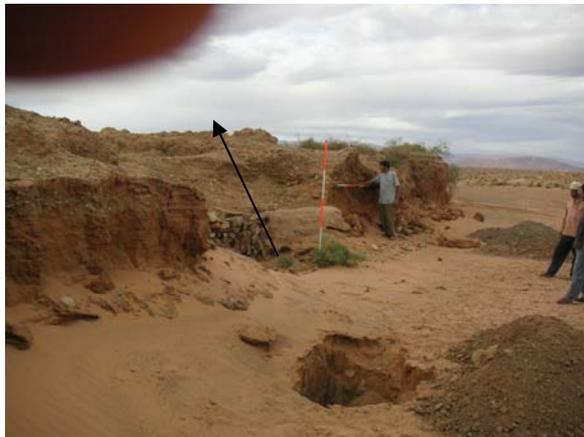
Erosion des berges. Le niveau d'eau se trouve à 1,2 m environ du lit de la rivière (le piquet horizontal indique le niveau d'eau)
