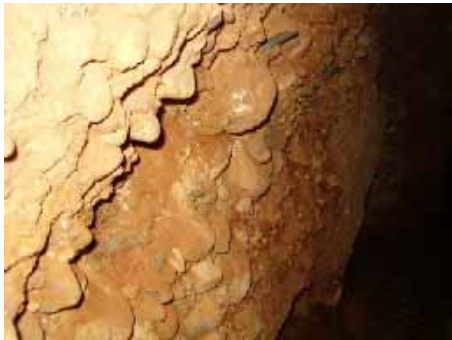
Gravier cimenté calcaireux et formation de galet à l'amont (formation d'infiltration)
