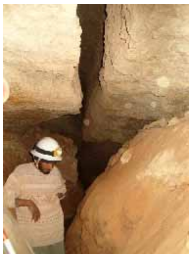
La partie supérieure est constituée de couches cimentées et la partie inférieure est composée de sable fragile (à l'aval)
