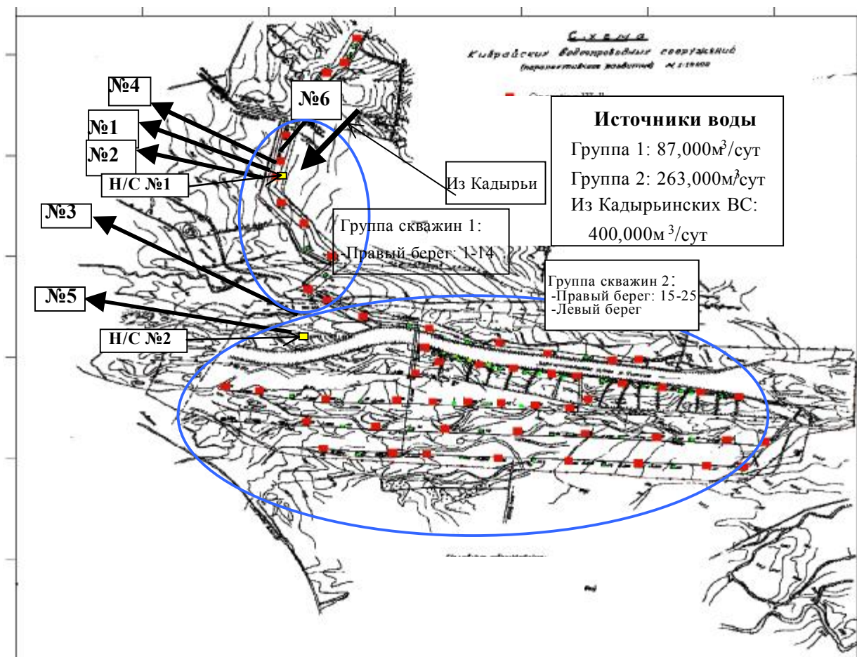
Рис. 5.4.6 Существующая распределительная система Кибрайских ВС
