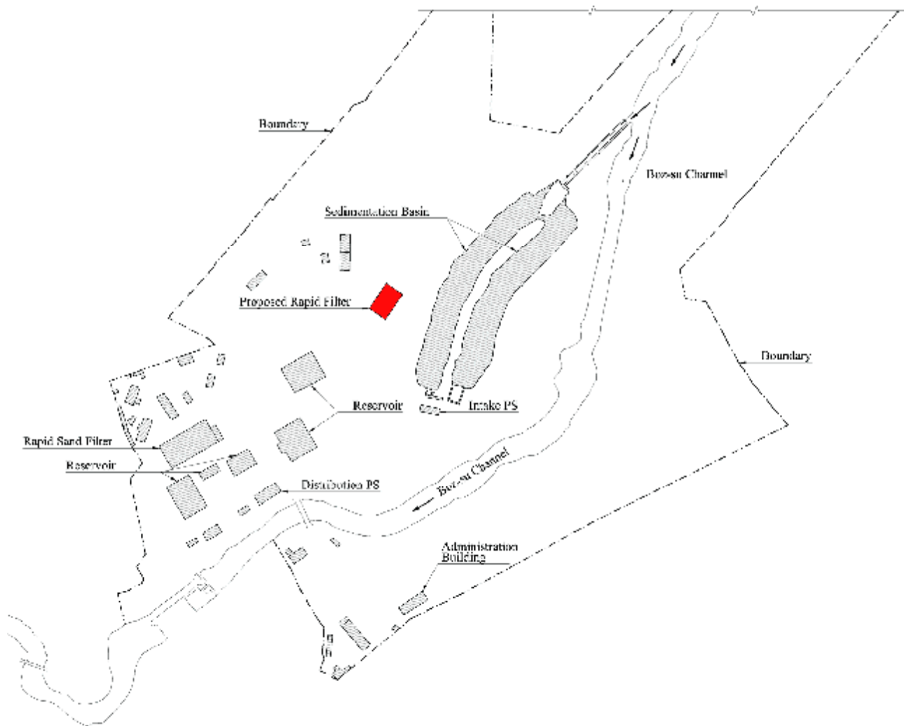
Рис. 5.4.7 Месторасположение новых скорых фильтров
