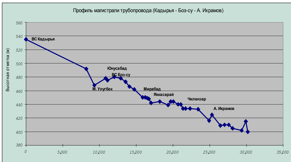
Рис. 5.3.3 (1) Продольный разрез от Кадырьинских ВС до города
