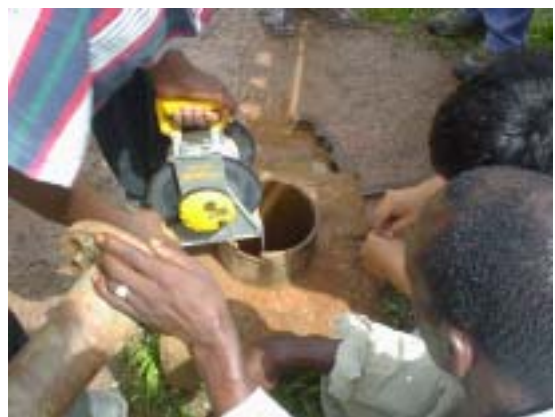
mesure de niveau d'eau (Fass Ndimbelene)
