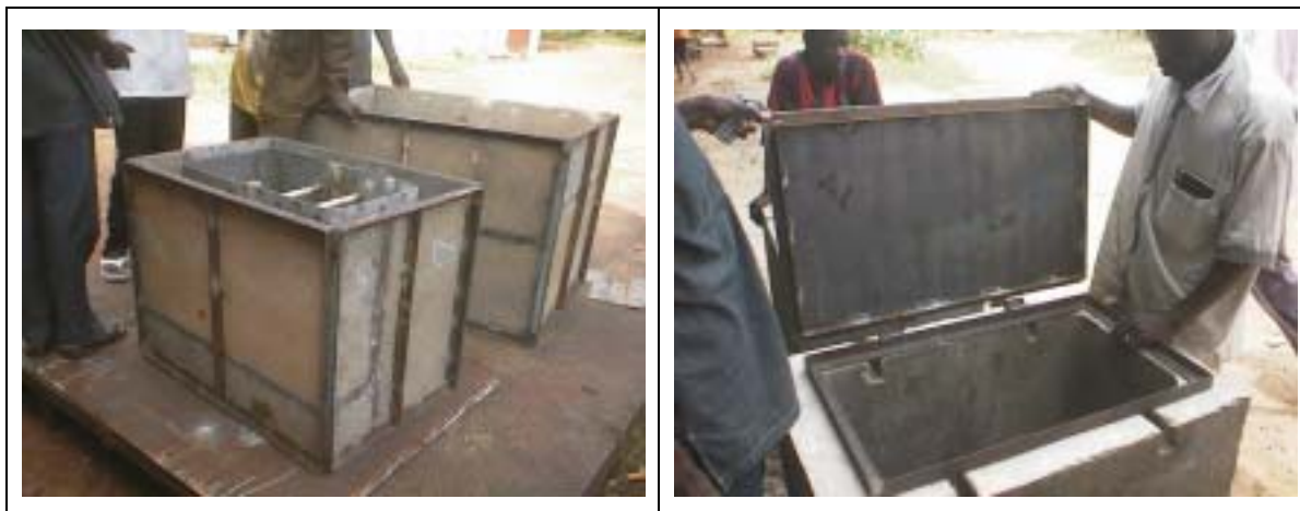
写真 7.4.2 DEM アトリエでのメータボックス製作
