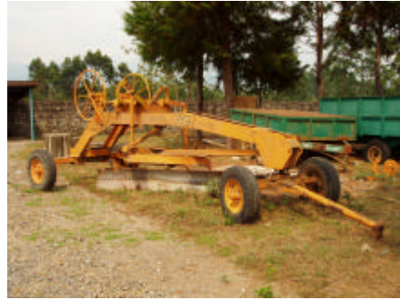
グレーダー及びウォーターバウザー
