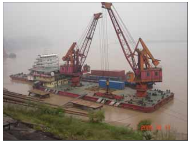
図表 Ⅲ-214 九龍坡のフローティング・クレーンとインクライン（左の線路と台車）
