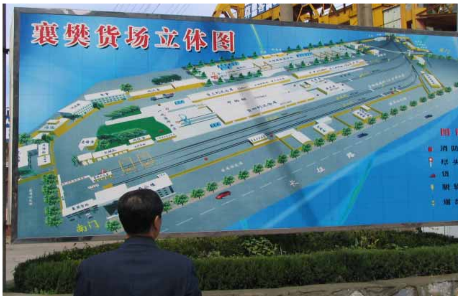
図表 III-127 襄樊貨物駅全体図。下側が車扱ヤードで上方がコンテナヤード。その向こうが本線。
