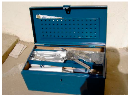
写真-40 インディア型ハンドポンプの修理工具 各地区の修理工に配布される Pumpenboese 社製 India Mark II ハンドポンプの修理用工具。
