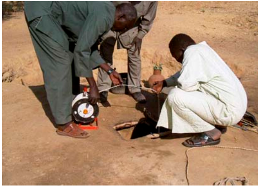
写真-25 Amoud Al Marfaine 村の手掘りピット クウェート基金のコンサルタントが地下水位を測定中 (6m)
