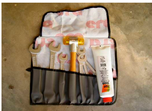
写真-39 インディア型ハンドポンプのメンテナンス工具 各村に配布される Pumpenboese 社製 India Mark II ハンド ポンプのメンテナンス用工具。
