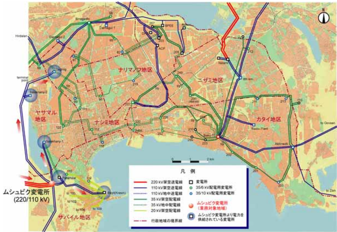
図 2.2-1 ムシュビク変電所の位置及びバクー市周辺の電力系統図
