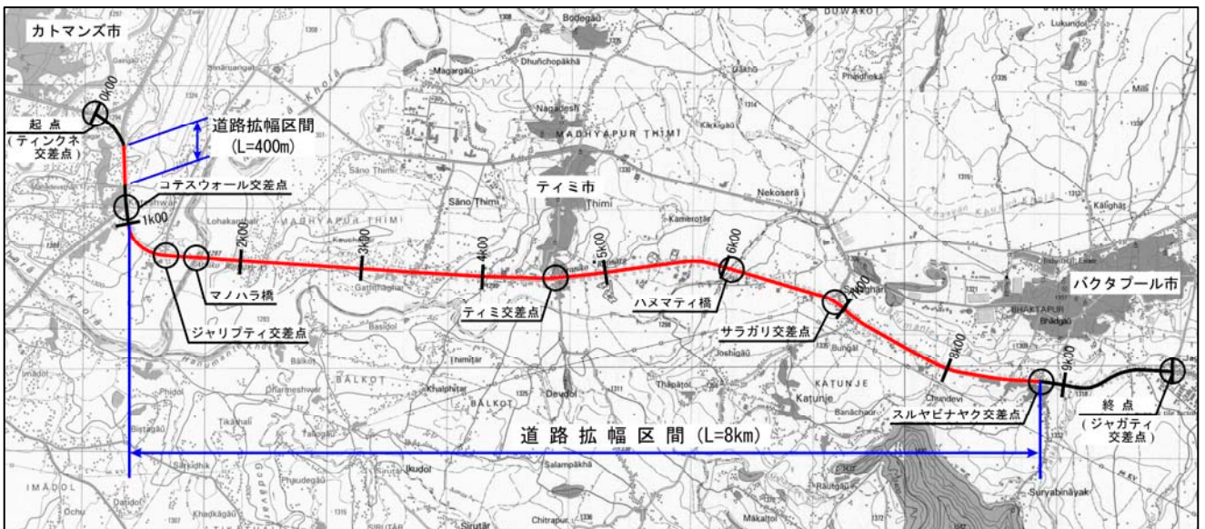
図 2-5 本調査対象道路の拡幅区間
