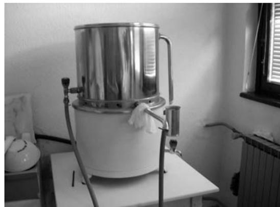
デミル・ヒサール HC/1990年代の蒸留水製造装置
