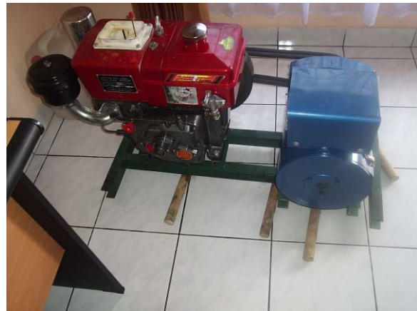
図2. 3. 8 バイオガス-ディーゼル発電機
