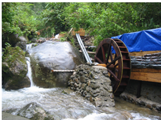
参考：インドネシアの個人用小水力発電（ソロ県）：現地で製作した木製水車と中国製の発電機 工事費(機材含む)はRp.5,000,000(6万円)程度という
