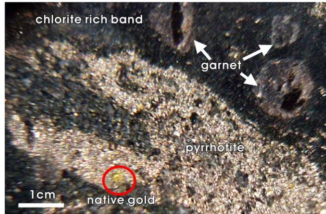
Fig. 4.3.7 Pyrrhotite et or natif avec des porphyroblastes de grenat dans la bande chlorite-amphibole
