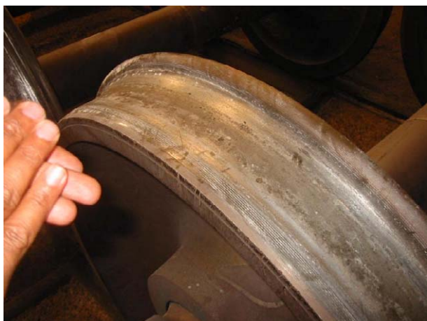
3. 砂漠の機関車の鉱石運搬への影響は大きく、軌条の砂による埋設、フィルターが目詰まり、車輪の摩耗が発生。写真は砂で著しく摩耗し修理を必要とする車輪の状態。
