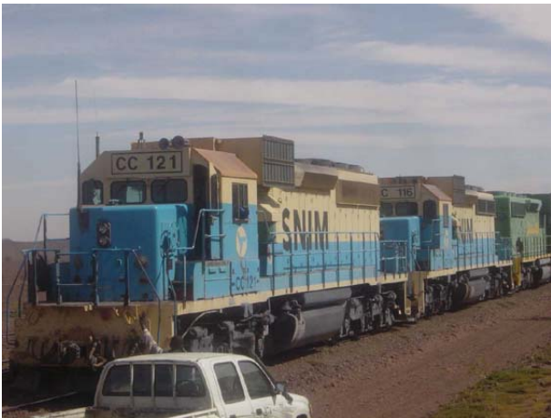
5. 鉄鉱石を運ぶ SNIM 鉄道の3重連機関車。
