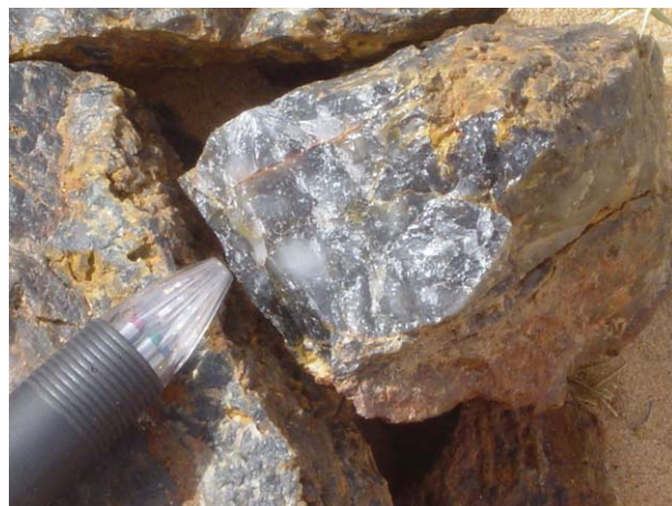
7. トレンチの石英 BIF が強く珪化を受け一見石英脈のように見える。微晶石英の集まりであり、milky quartz~black quartz を呈する。このタイプの石英脈に金 1g/t がくることがある。
