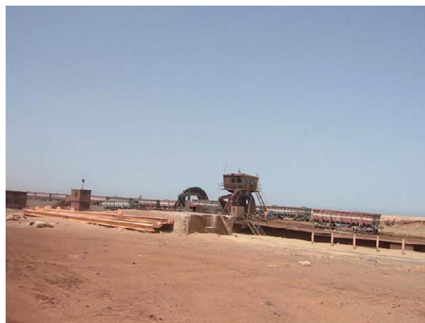
4. チッラーの外観。2つの円形の設備で鉱車を固定、回転し鉱石が落ちる。落下した鉱石は地下のベルコンで貯鉱場(写真撮影不可)に送られる。貯鉱場はから、再び破碎場に送られ、一旦貯鉱し、船積みされる。粉鉱の粉塵が鉱石が落下すると発生する。
