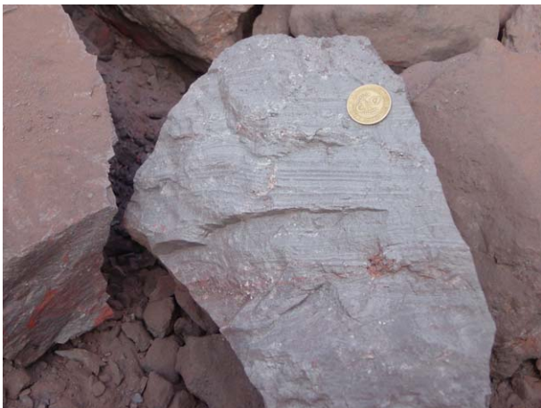
7. Tazazit の TO14 鉱床。高品位部でいわゆる「Blue hematite」と称す。SpecularOre で品位は67~68%Fe、微晶な赤鉄鉱と石英からなる縞状構造が明瞭。
