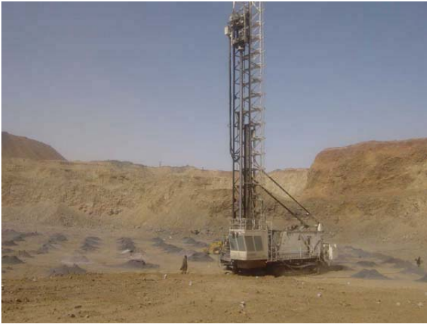
3. El Rhein 鉱山での穿孔風景。深さ 18m を掘削。孔毎に ANFO 火薬を 1 トン挿入し、一回の発破で 3,000 トンの鉱石を起す。
