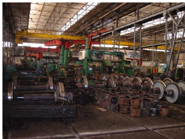
2. 鉱車修理ショップの様子。修理部品が配置。鉱車は積載重量80t(総重量100t)の本格的なもので3ヶ国から輸入。鉱車の総数は1,200台であり、3種の型式。
