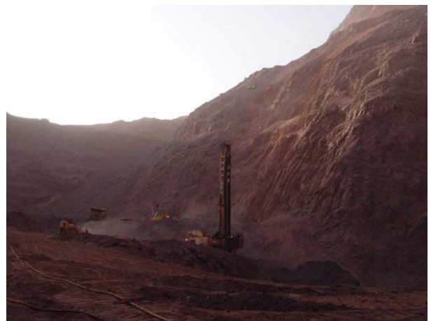
2. Tazadit T014 鉱床。現在の主力露天掘で、年間採掘量は19百万トン。鉄鉱石は赤鉄鉱からなり、45%Fe の高品位鉱。
