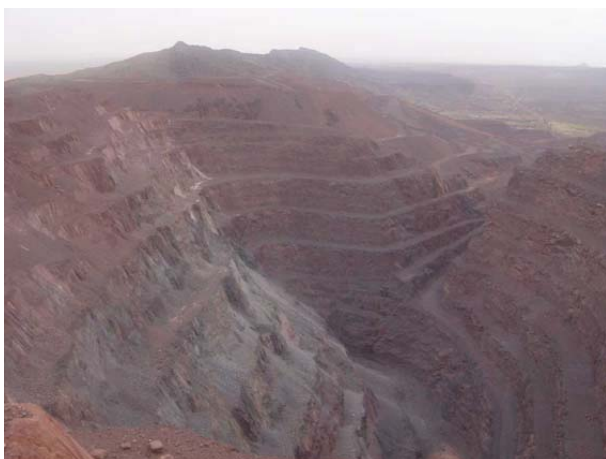
1. Tazadit T01 鉱床の鉄鉱石露天掘跡。ピット規模は長さ 700m(E-W), 最大幅 500m(N-S), 深さ 500m。
