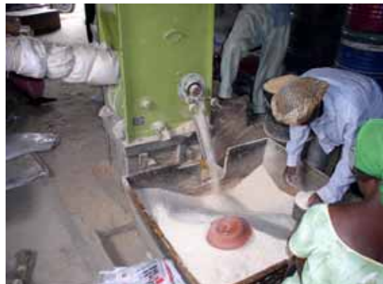
小規模精米所（小石・不純物の混在）
