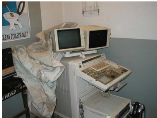
電圧降下により使用できない装置(ジラパ郡病院)
