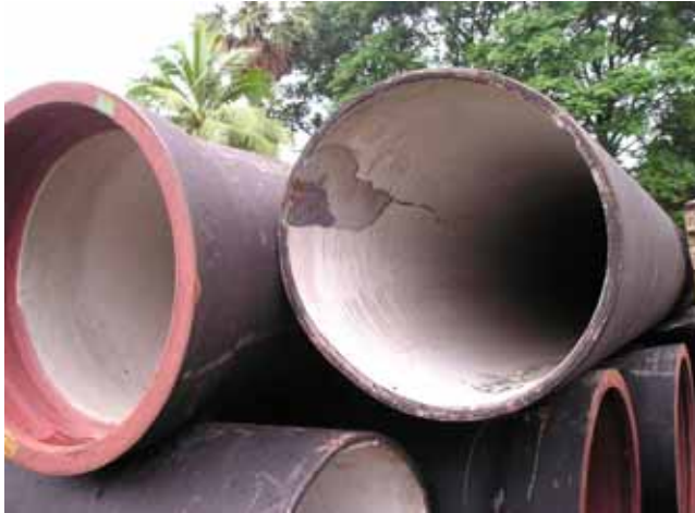
購入されたベトナム製ダクタイル鋳鉄管 (品質に問題がある)
