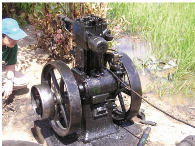
写真7 ティラベリ地方の水田で使用されていたインド製の灌漑ポンプ
