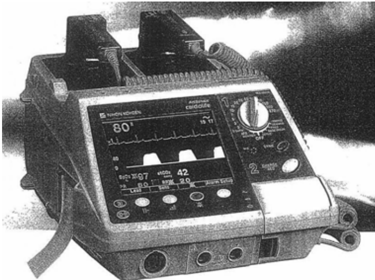
Portable Heart Monitor with Defibrillator 電気除細動器 小型、処置前後の心電図をモニタリング
