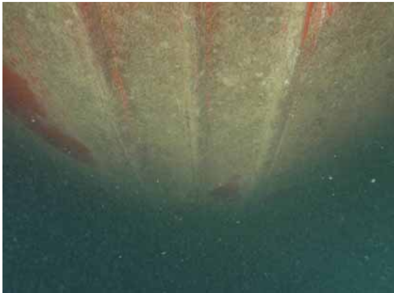
大型定期船 ODESANGEL_DIL船底 (海底面と擦った形跡)
