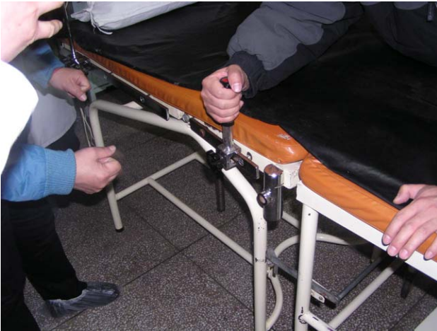
大同市母子保健所 分娩台（取り付け部分劣化により破損）
