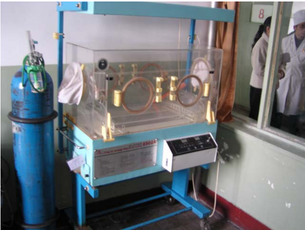
朔州市母子保健所 保育器（温度調節が出来ない）
