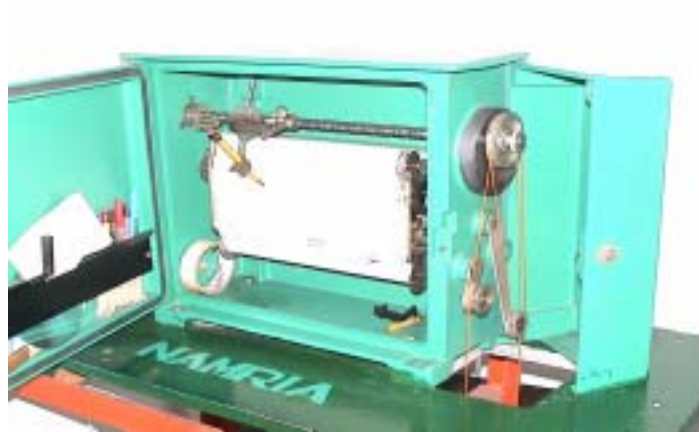
図 10 (写真)鉛筆で記録するタイプの験潮器
