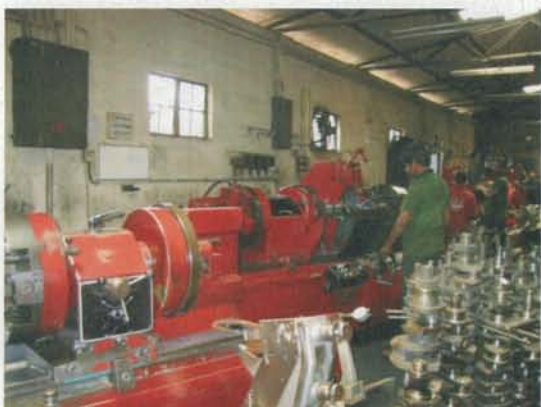
コロombo市内の機械加工工場内部 普通旋盤 船用クランクシャフトの研削作業
