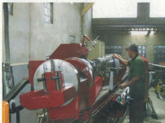
左同 長尺普通旋盤 船用プロペラシャフトの研削作業
