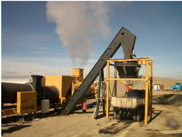
ボリビアの大手建設業者のアスファルト・プラント (CONCORDIA 社)
