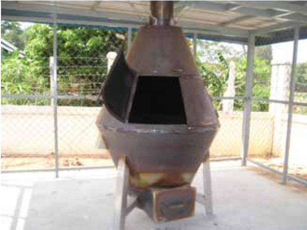
写真1：小型簡易焼却炉（第1期調達機材）
