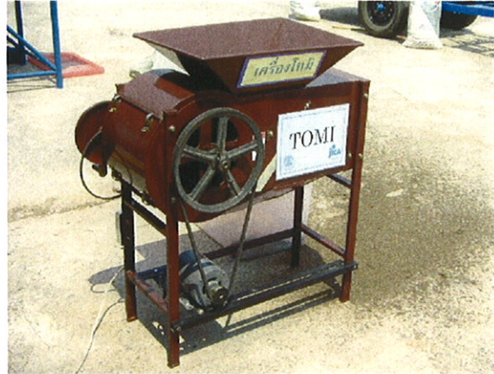
プロジェクトで製作した簡易種子精選機(トウミ)
