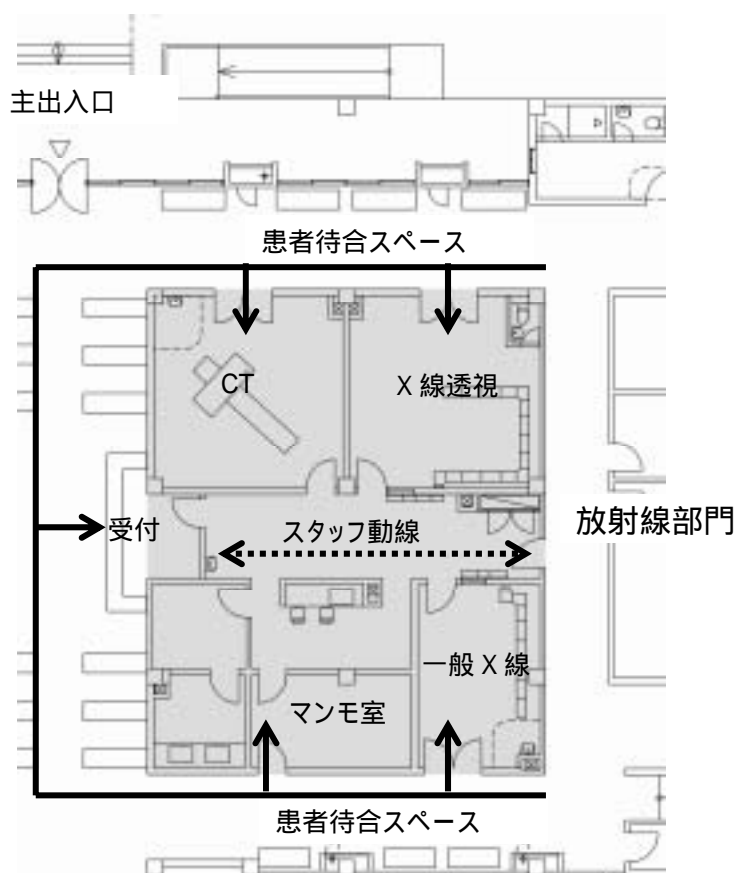
図 3-3 技術棟 1階 放射線部門
