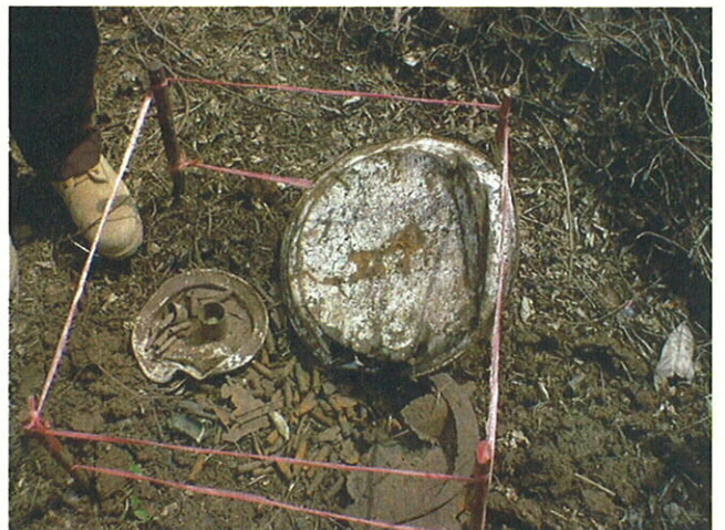
地雷除去の地雷本体と金属破片 金属破片でも探知機は反応するため除去作業は時間を要する。
