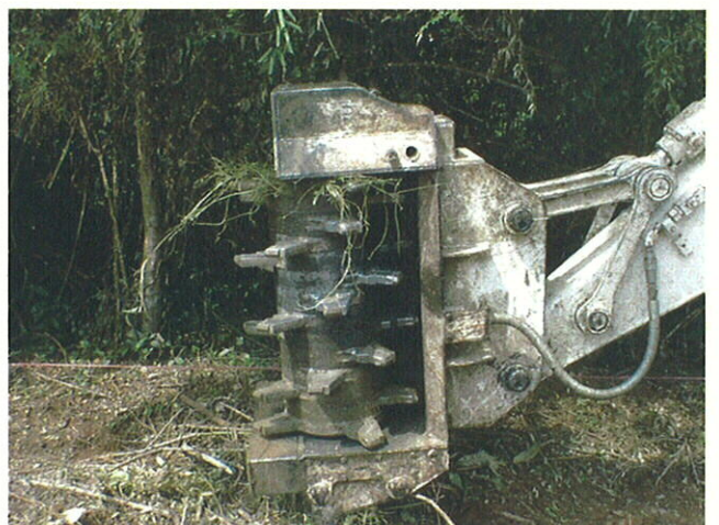
灌木除去機のカッター部分 現時点でもカッターの刃の交換はされていない。
