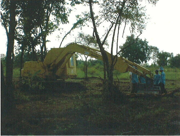
小松社製 灌木除去機 10トンクラスで、大きな灌木以外に対応している。
