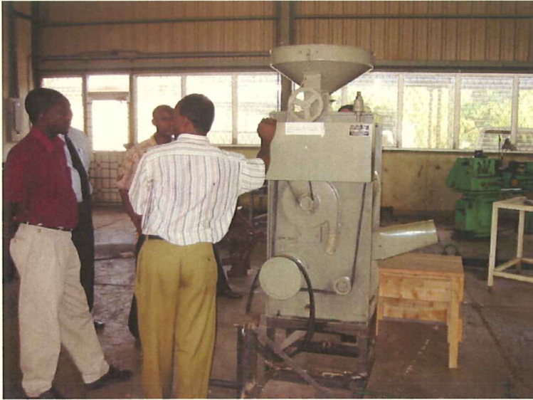
キリマンジャロ農業技術者訓練センター (KATC) 作業場 1 トラクターの動力を利用した脱穀機の試作品
