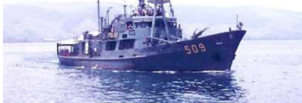
総トン数:410トン/全長(LOA):48.6m/主機関:640ps×2/速力:12ノット/製造年:1962年/日本製
