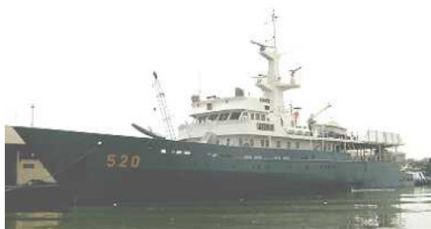
総トン数:620トン/全長(LOA):61m/主機関:4,100ps×2/速力:22.8ノット/製造年:2003年/スペイン製
