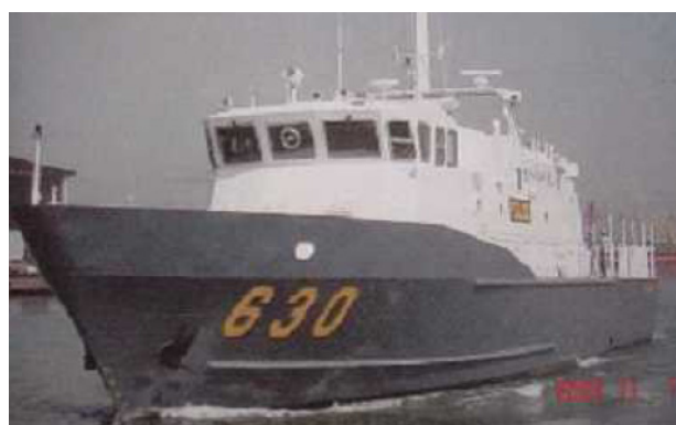
総トン数:156トン/全長(LOA):34.5m/主機関:2,040KW×2/速力:28ノット/製造年:2003年/シンガポール製(英国ライセンス)
