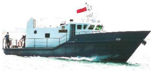
総トン数:36トン/全長(LOA):17m/主機関:650KW×2/速力:36ノット/製造年:2003年/シンガポール製(英国ライセンス)
