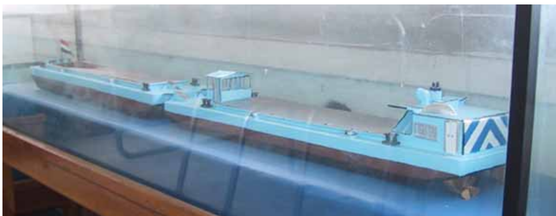
写真 - 1 内水バージ輸送方式モデル(2 ユニット運搬方式)
