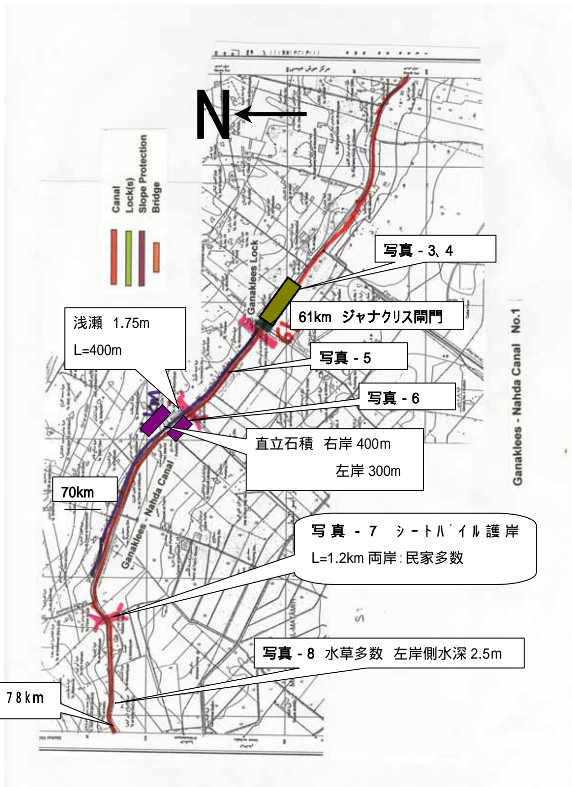
図 - 6 - 1 ジャナクリス - ナハダ間運河 (61km - 78km)
