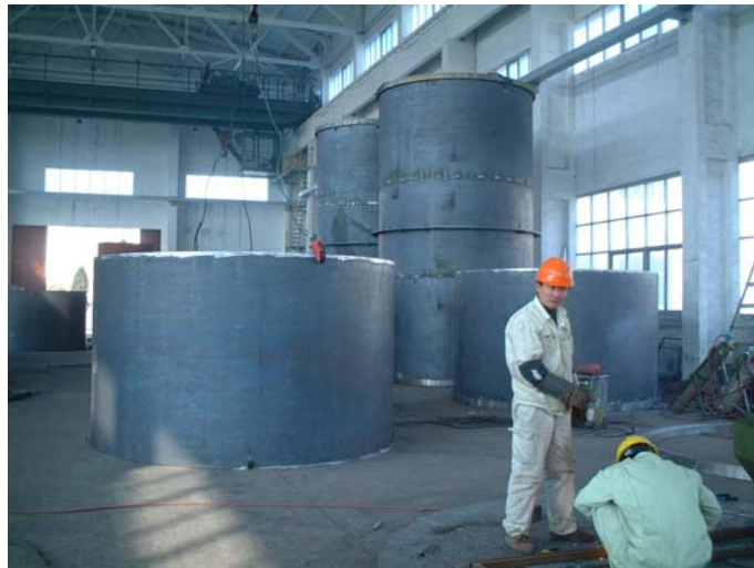
浄化槽メーカーの視察（宜興市）。鉄板による浄化槽が量産されている。
