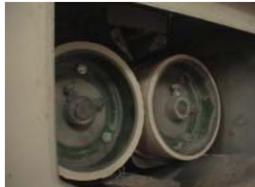
写真 16. デビ・チゲ地区:ゴムロールの隙間が広すぎる
