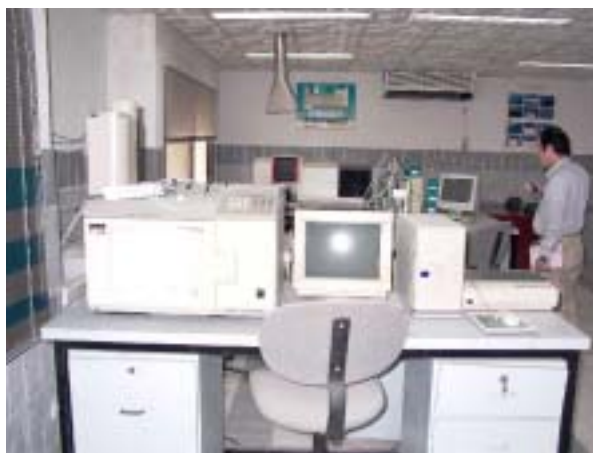
写真-5 シンド州環境保護局 機器分析室 原子吸光分析計、ガスクロマトグラフ等が置かれているが付属品等の不足により、十分な測定が実施できない。
